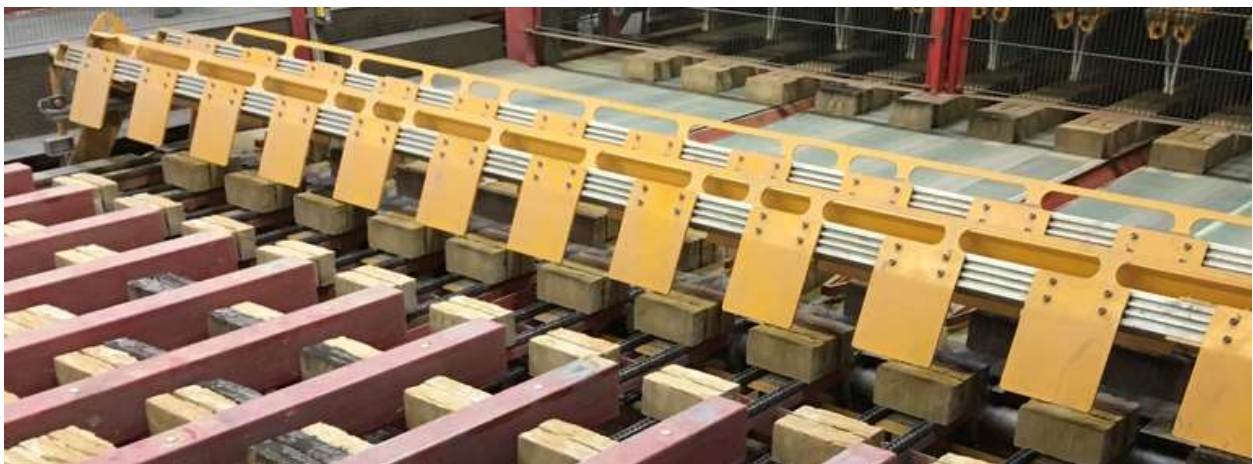
Figuur 5: vormingsproces van bakstenen
