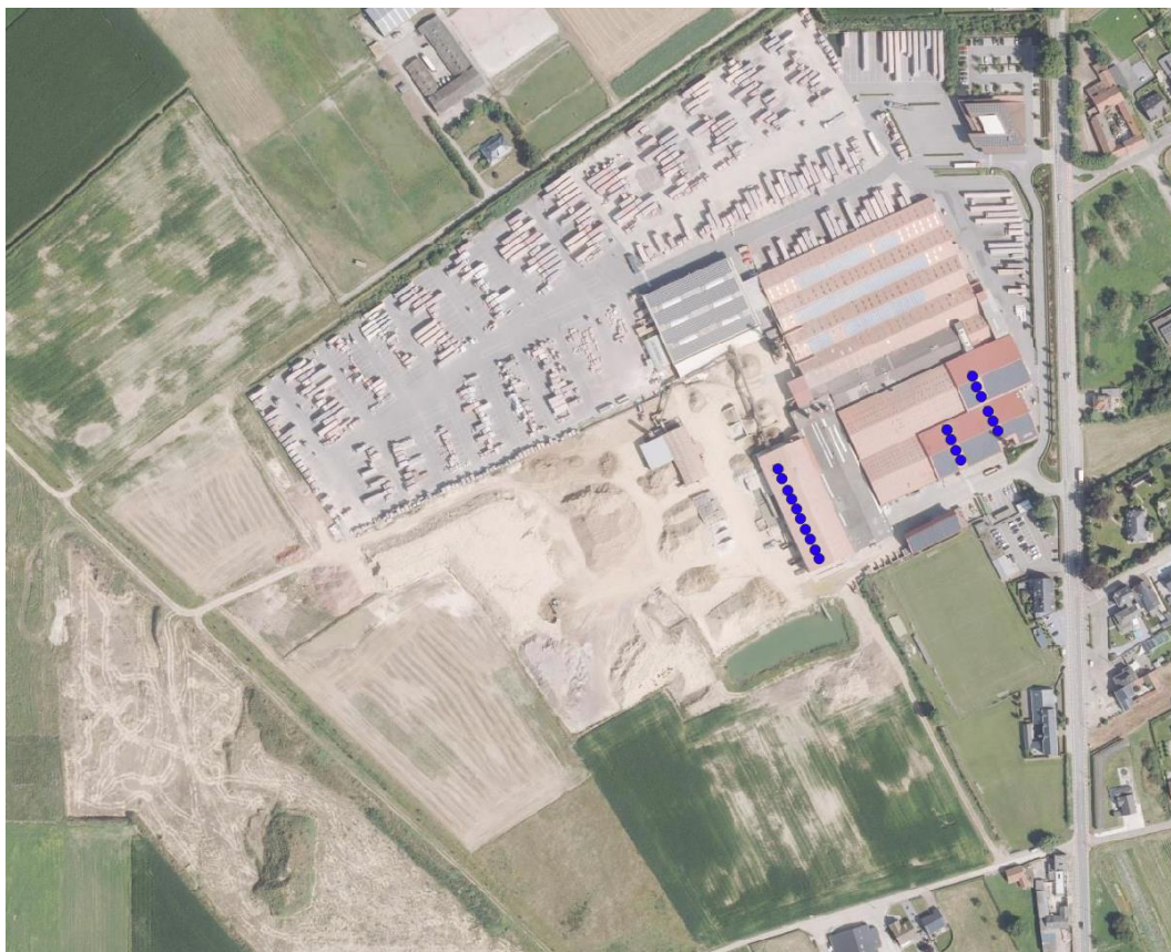
Figuur 2: Locaties van de emissiepunten voor de drogerij.
