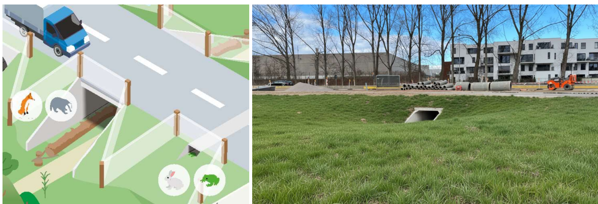
Figuur 24: Principe van een eco-tunnel en aankomstzone voor grotere zoogdieren (vademecum natuurtechniek en voorbeeld WADR).
