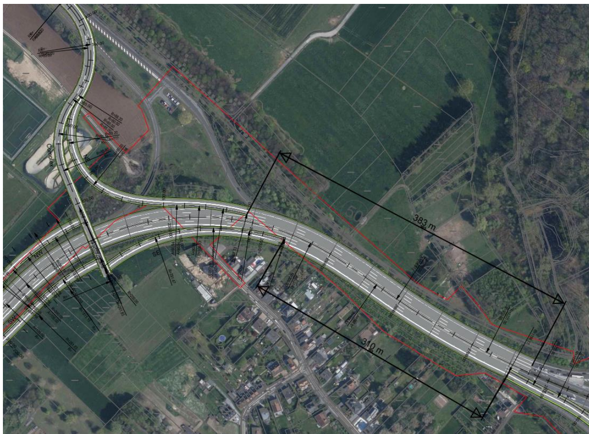
Figuur 20: Aanduiding weefvaklengte 383m – hoek rijbanen 7% (versie uitwerking ASC Welkomstlaan – alternatief 1)
