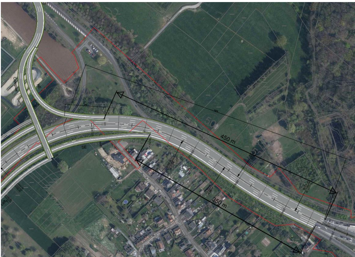
Figuur 22: Aanduiding weefvaklengte 450m – hoek rijbanen +10% (geüpdatete versie uitwerking ASC Welkomstlaan – alternatief 1)
