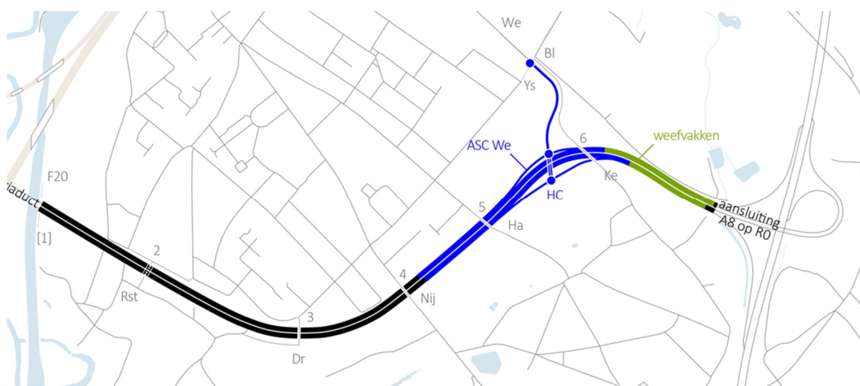
Figuur 23: Aaneenschakeling van ongelijkvloerse kruisingen A8 en positie weefvakken in relatie tot aansluitingscomplex A8xWelkomstlaan
