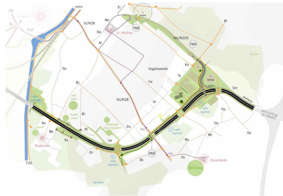
In de variant zonder lokale verbindingsweg ligt de fietsverbinding ingebed in de berm langs de A8. Het autoverkeer van de A8 gaat via het aansluitingscomplex naar de Welkomstlaan.
