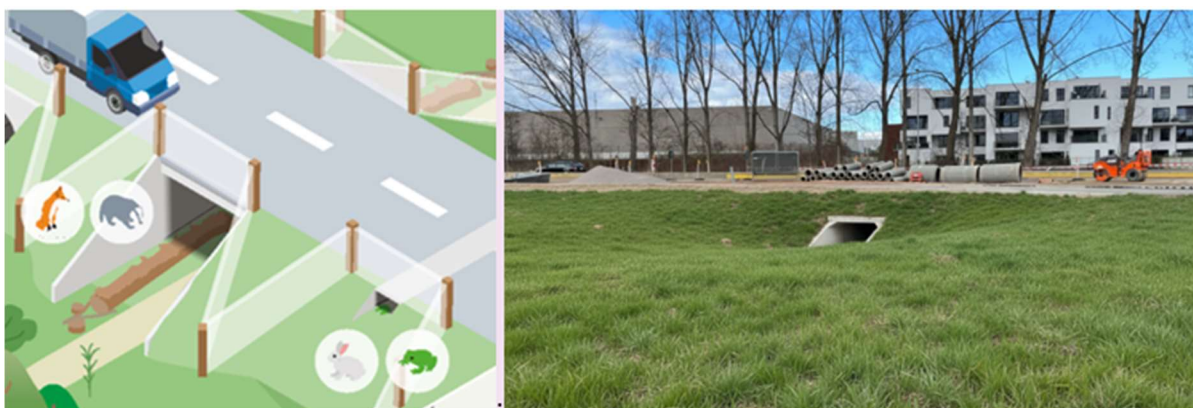
figuur 36: Principe van een grote ecoker met aankomstzone voor grotere zoogdieren (vademecum natuurtechniek en voorbeeld WADR)
