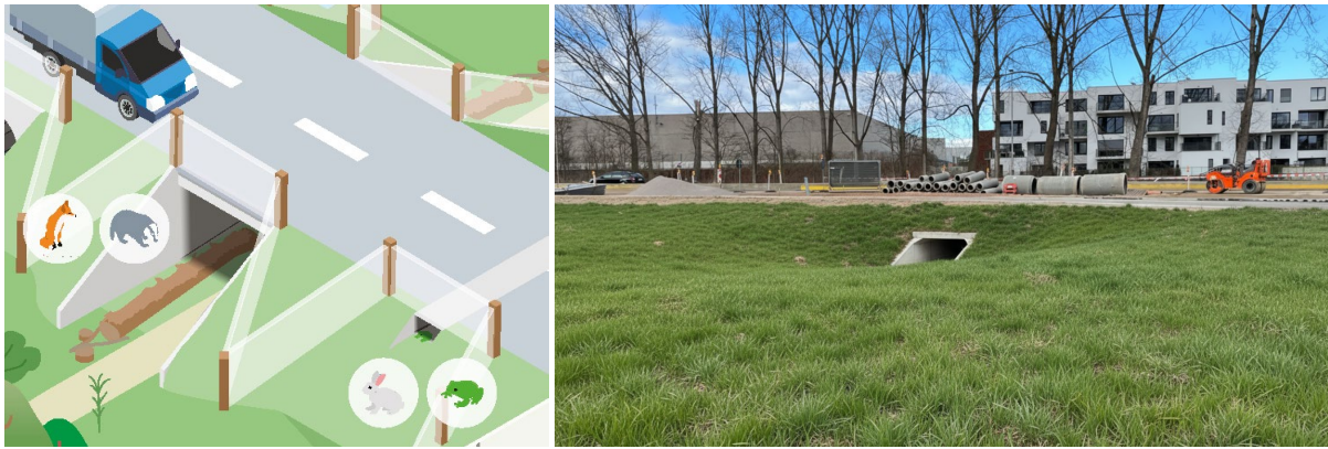
Figuur 24: Principe van een eco-tunnel en aankomstzone voor grotere zoogdieren (vademecum natuurtechniek en voorbeeld WADR).
