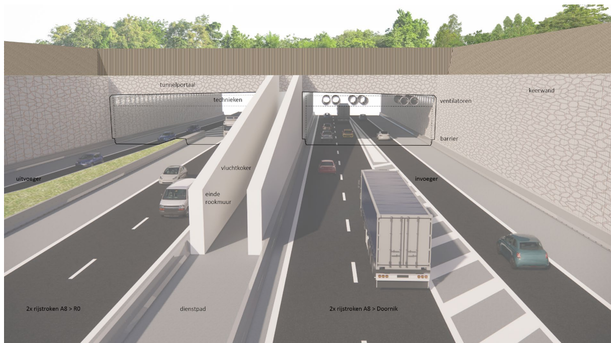
Figuur 14: Overzicht oostelijk tunnelportaal met uitgang vluchtkoker, A8, invoeger en uitvoeger aan het tunnelportaal.
