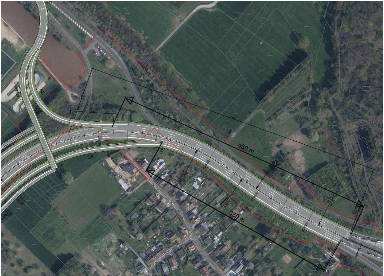
Figuur 32: Aanduiding weefvaklengtes (eerste inpassing ASC Welkomstlaan – alternatief 1)
