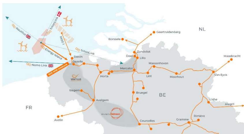
Principe van ‘vermazing’ binnen het elektriciteitsnet
