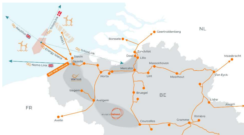
Principe van 'vermazing' binnen het elektriciteitsnet
