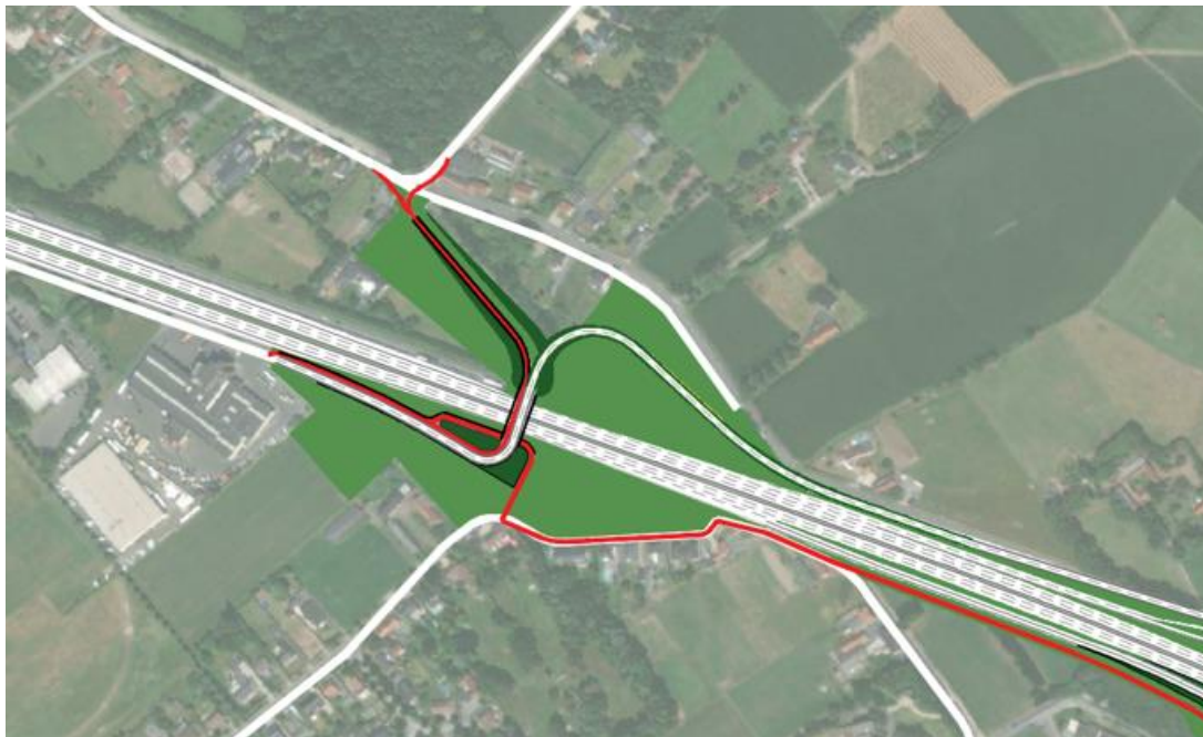
Figuur 8: Alternatief A: Kloosterstraat brug met knip lokaal gemotoriseerd verkeer
