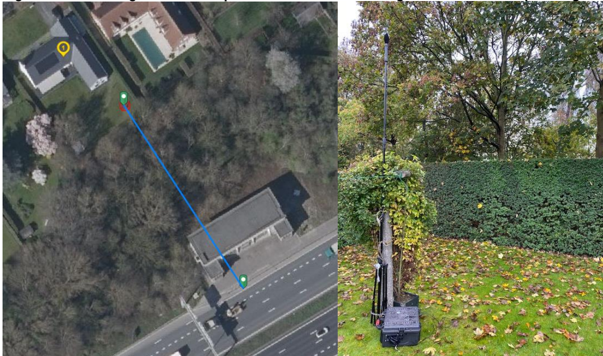
Figuur 3: aanduiding van het meetpunt met afstand tot de weg en foto van meetopstelling
