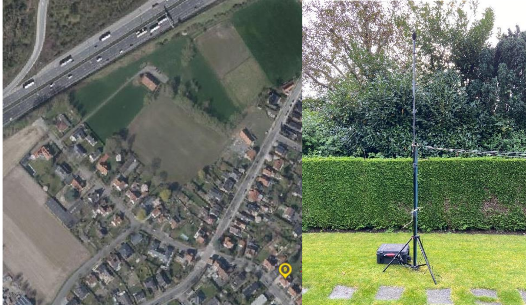
Figuur 11: aanduiding van het meetpunt met afstand tot de weg en foto van meetopstelling
