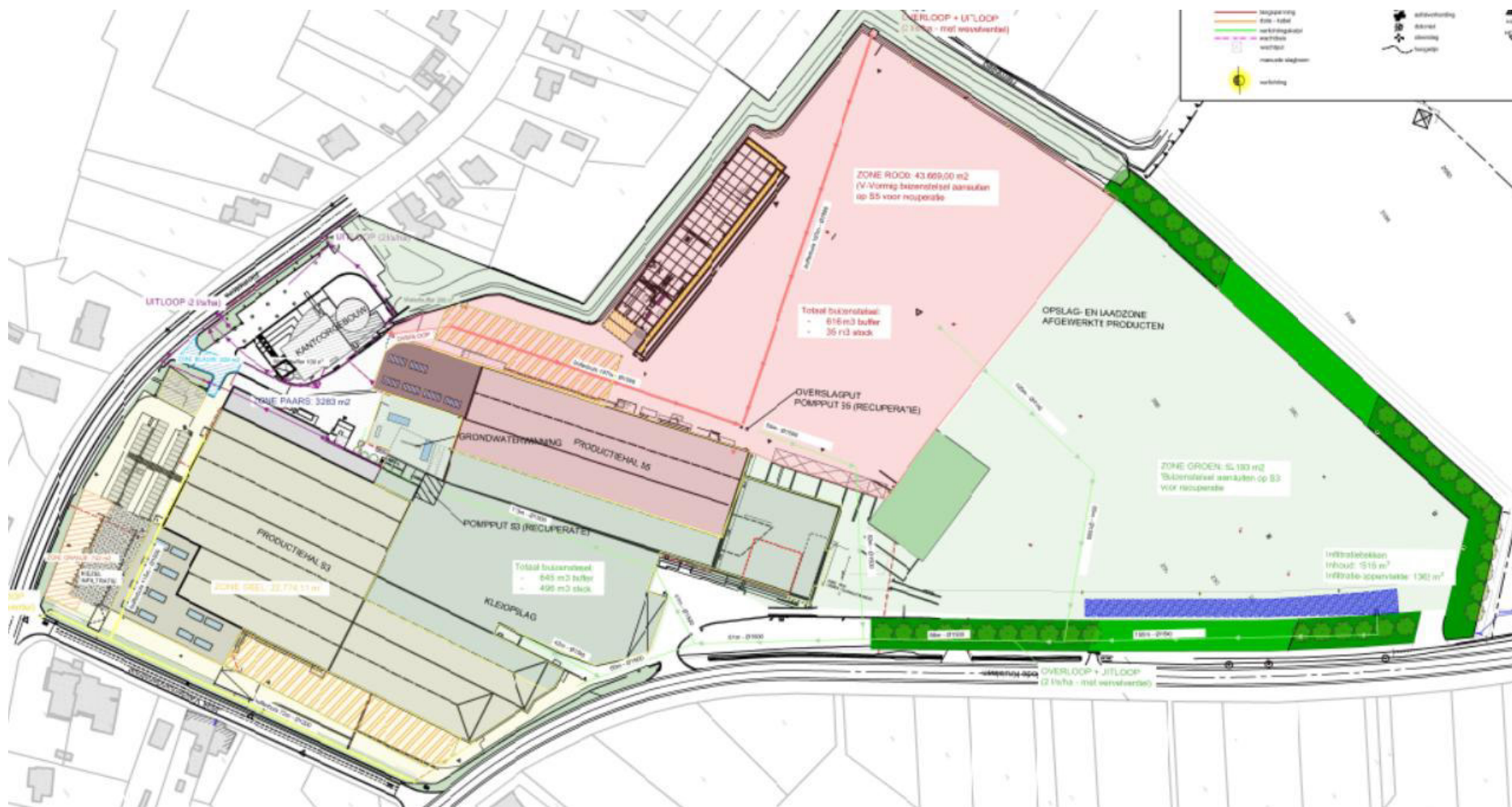
Figuur 20 Inplantingsplan hemelwaterhuishouding van de bestaande site en de uitbreiding. De site is opgedeeld in verschillende kleurzones om de opvang en afvoer van het hemelwater te visualiseren. Deze kaart kan met een hogere resolutie ook teruggevonden worden in bijlage. (Bron: Cyclops Project Management)
